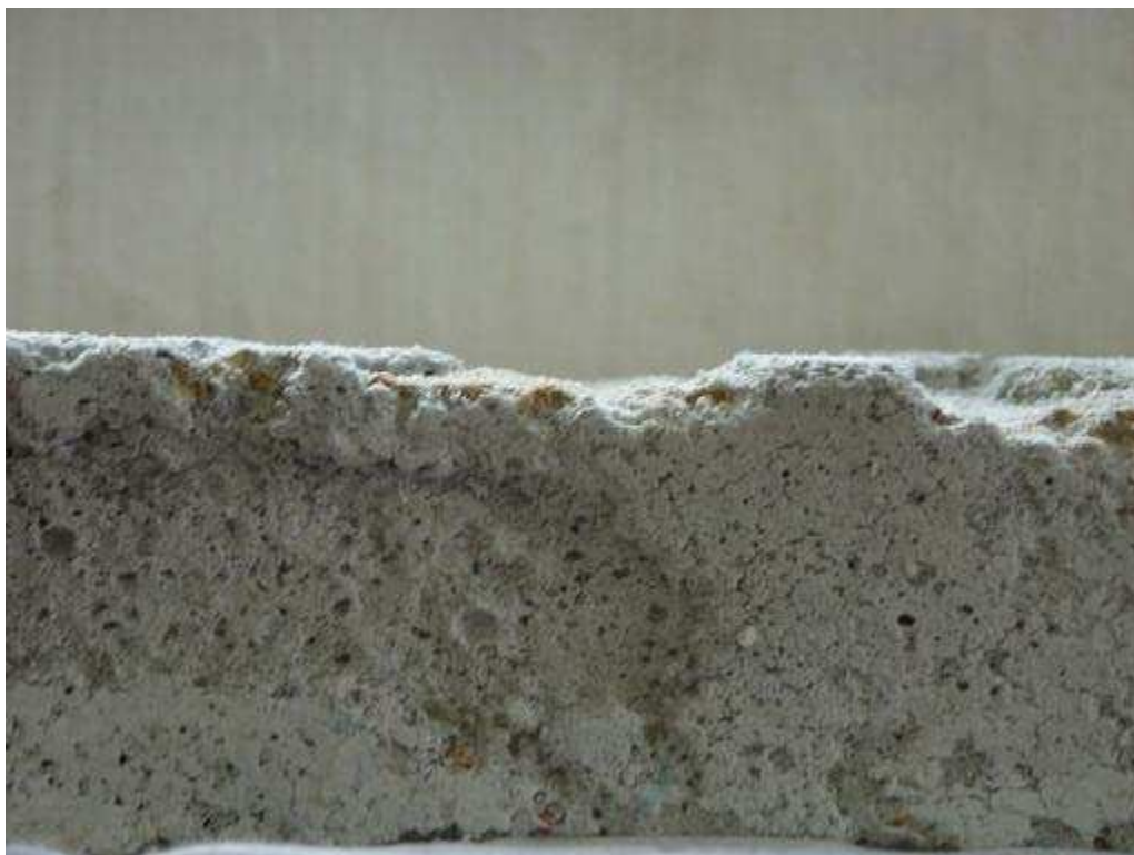
Abbildung 6: Frontansicht eines Probekörpers ohne Evercrete Behandlung (10-%ige HCl – 11 Tage)
