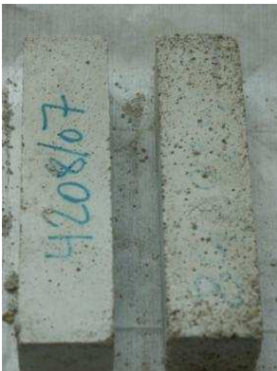
Abbildung 2: Probekörper mit Evercrete Behandlung (10-%ige HCl – 11 Tage)
