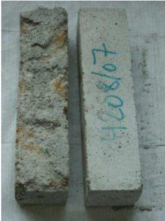
Abbildung 3: Vergleich Probekörper mit bzw. ohne Evercrete Behandlung (10-%ige HCl – 11 Tage)
