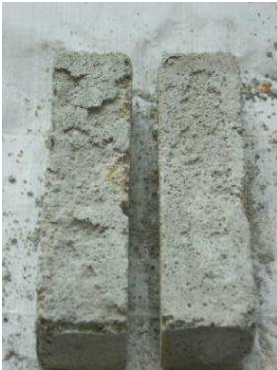
Abbildung 1: Probekörper ohne Evercrete Behandlung (10-%ige HCl – 11 Tage)
