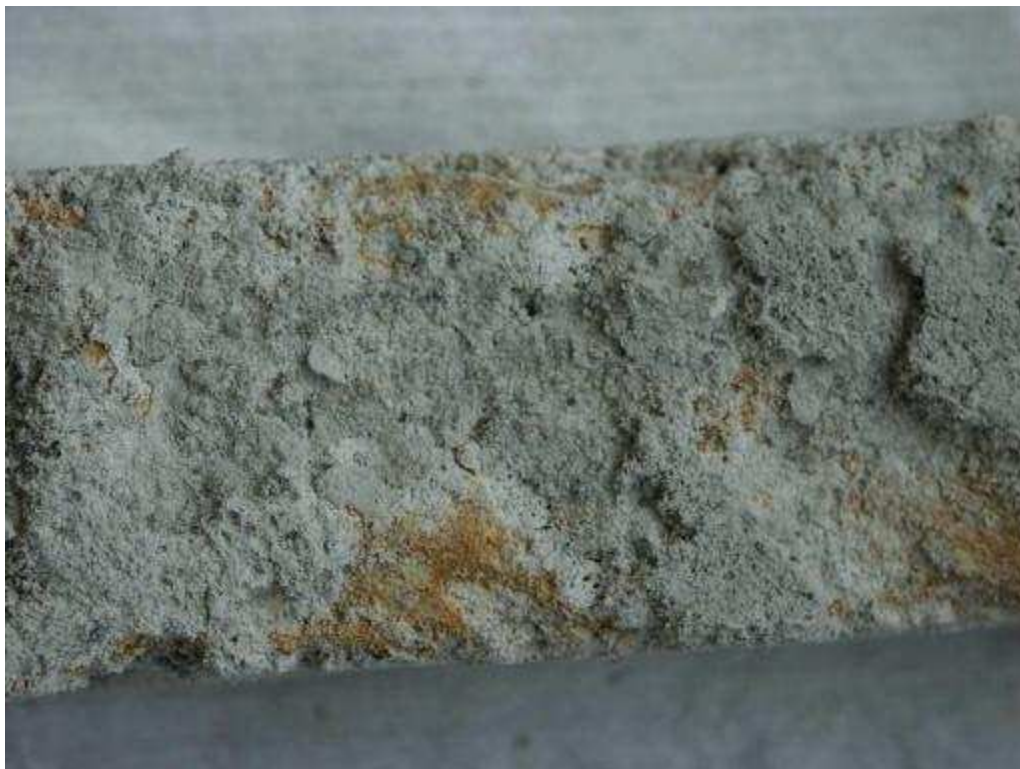
Abbildung 4: Probekörper ohne Evercrete Behandlung (10-%ige HCl – 11 Tage)
